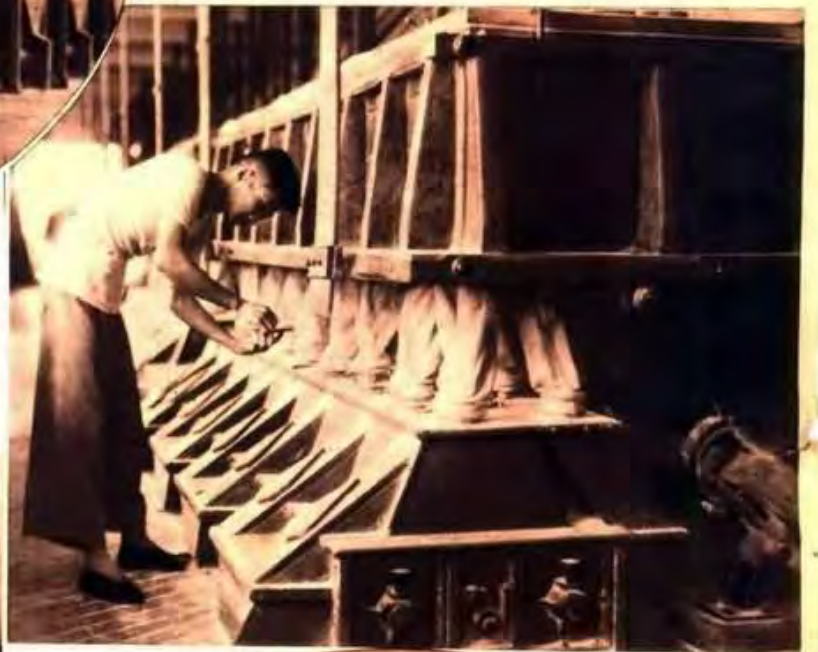
→磨成的粉，經過方篩的篩折，分為頭、二、三、四種的粉質。 個較次的三四號粉，由方篩轉入圓篩，篩淨，其不能成爲粉的麥皮即轉入麥皮機。
