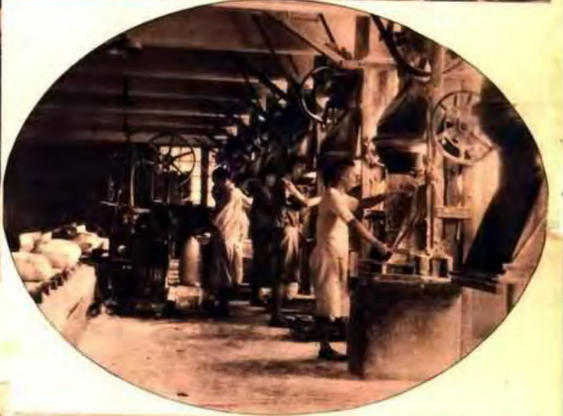
→磨成的粉，輸入裝包機，裝成一包，每包都經過磅重。 個粉經鍊粉機，鍊的漂鍊，色澤更爲白淨光潔。
