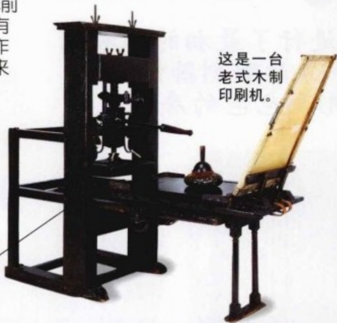
这台印刷机的不同部件都需要人手工操作。
