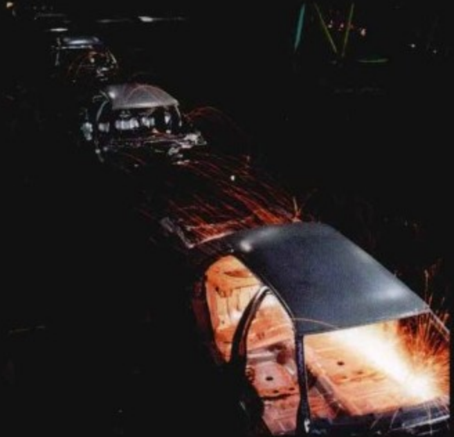
机器人使用焊枪将汽车部件组装起来。
