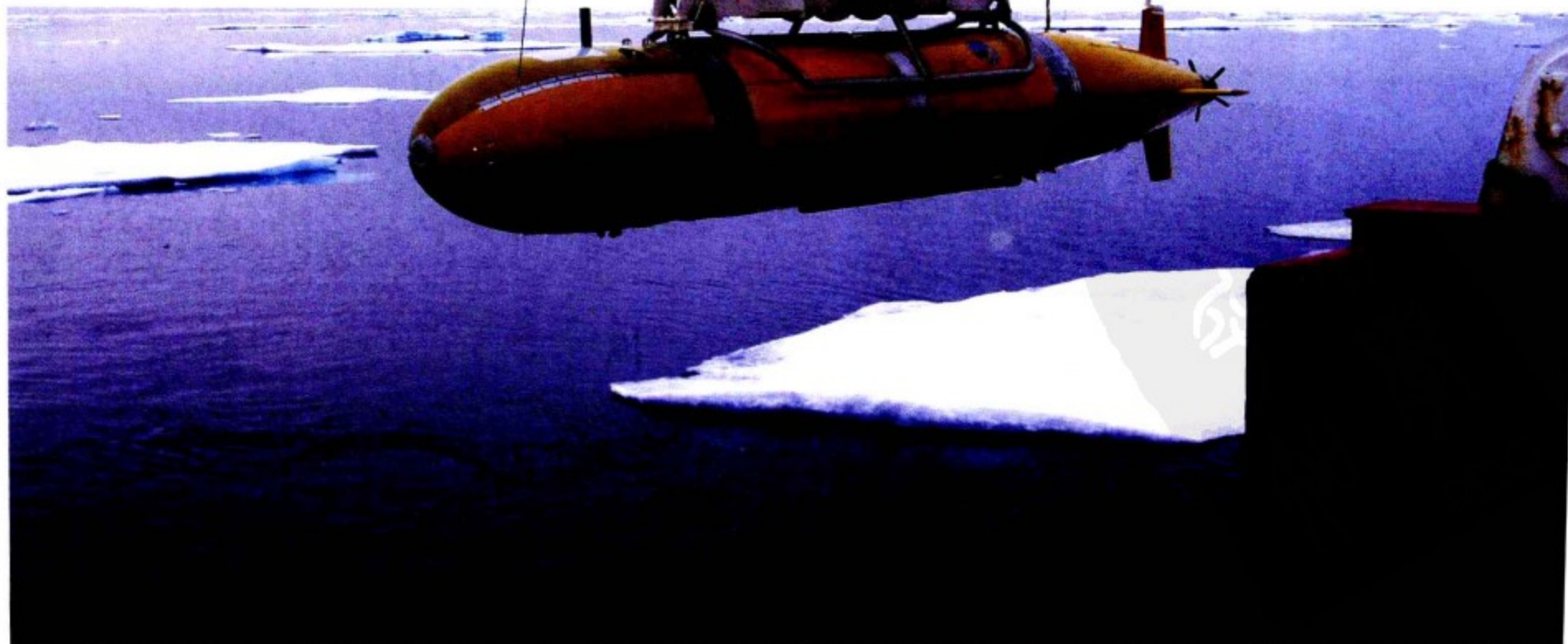
将低级自动潜水艇送入水中的机械臂
