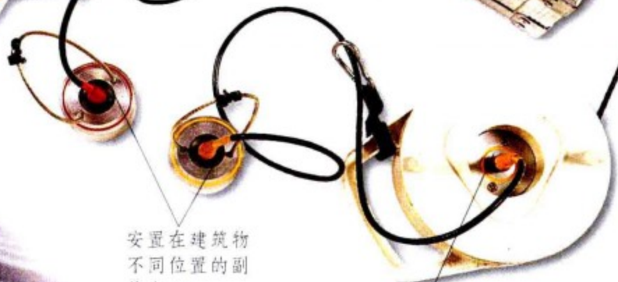
线图让传感器得以移动，以便监测不同的方位
