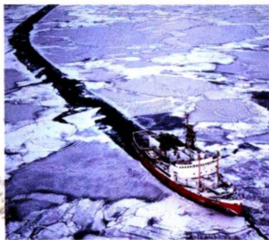
具有钢制船体的破冰船粉碎冰块，为其他轮船开辟航道
