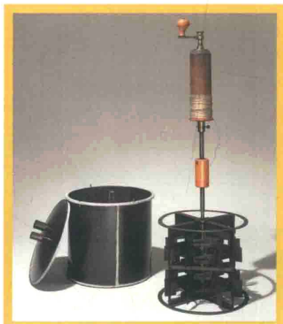
在焦耳的实验中,落体驱动叶轮在一桶水中转动,动能因此转化为热能。
